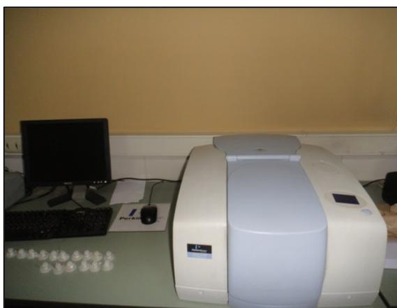
**Figura 2.11. Instrumento FTIR**
