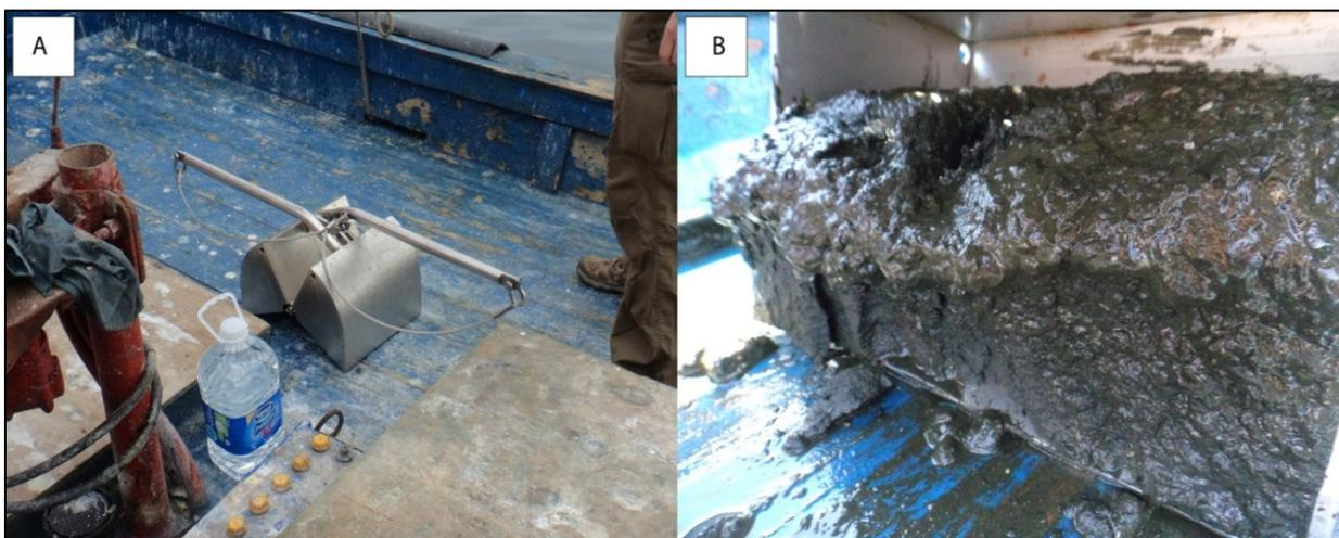
**Figura 2.3. Muestreo del fondo marino. A) Draga "cuchara". B) Recolección de muestra en draga.**
