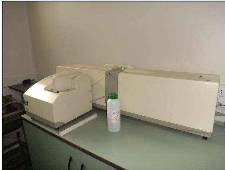
Figura 2.6. Granulómetro *Malvern Master Sizer 2000*.
