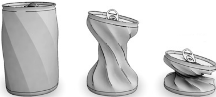
Diseño creado por Choi Kwenyoung y Park Jiwoon en la cual consiste en una lata que posee una estructura en espiral, permitiendo facilitar el aplastamiento del envase una vez terminado de utilizarlo.
