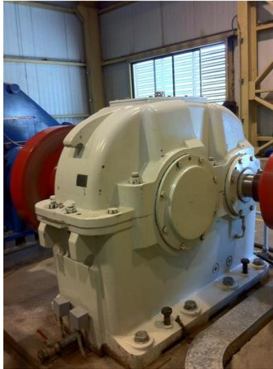
Figura 2.44: Sistema multiplicador de velocidad, central Eyzaguirre 1,9 MW.
