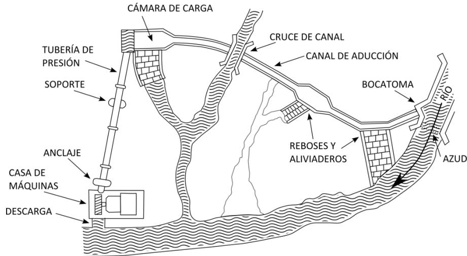
Figura 2.2: Instalaciones típicas de una mini central hidráulica [3]
