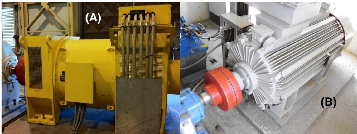
Figura 2.46: A) Generador Síncrono de 1,9 MW y B) Generador de inducción de 270 kW.
