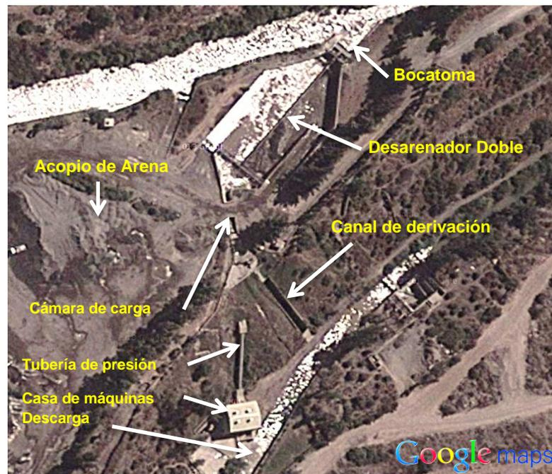
Figura 3.17: Layout general de las instalaciones de la central Eyzaguirre.
