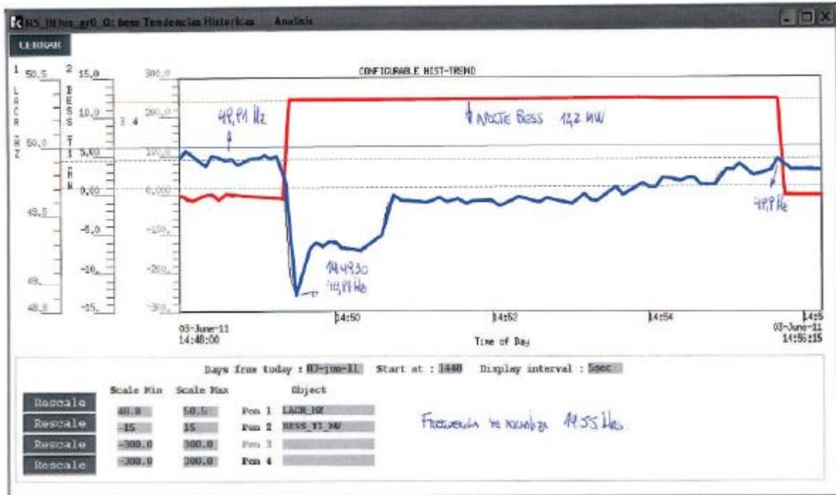
Figura 16. Respuesta del sistema BESS para CPF en el SING. Fuente: Almacenamiento de Energía: Modelos de Negocio y Ubicación Óptima, Ronny Muñoz M, 2013.
