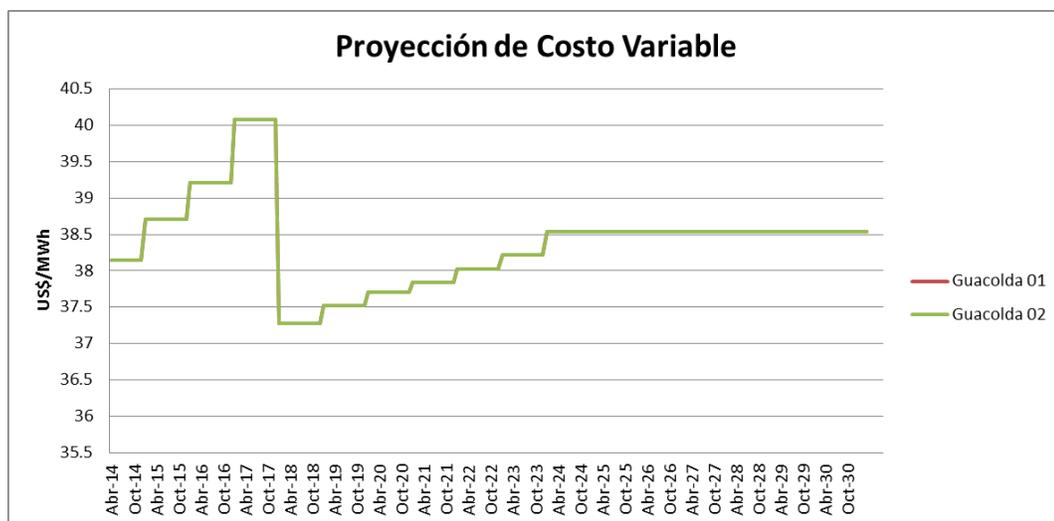
Figura 23. Proyección del Costo Variable para las Unidades 01 y 02 de Guacolda en la Barra de Conexión Maitencillo 220 para el Caso Base.
