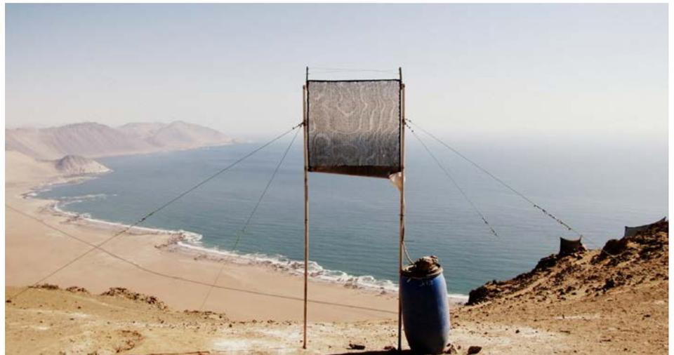
13. Neblinómetro (de pequeñas dimensiones (1 m<sup>2</sup>) se utiliza para medir y monitorear la calidad y captación del agua de niebla).
