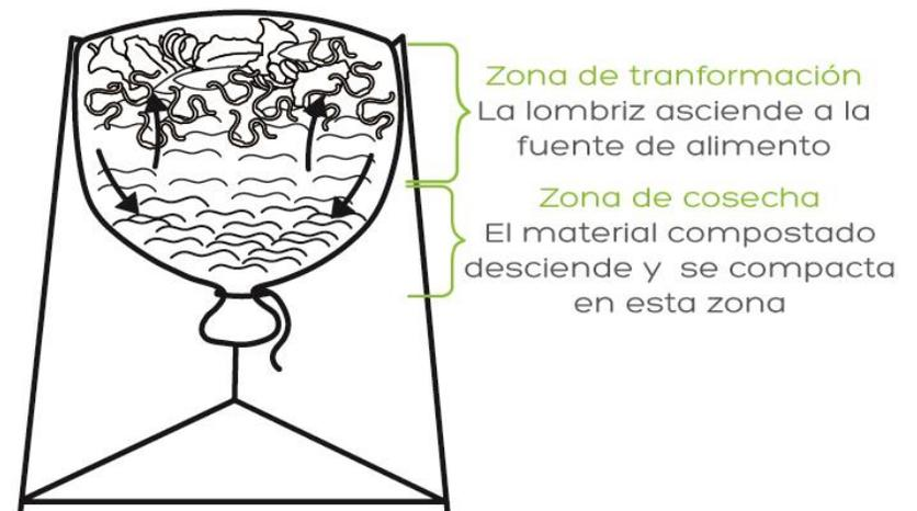
Esquema vermicompostaje en sistemas de flujo continuo.
