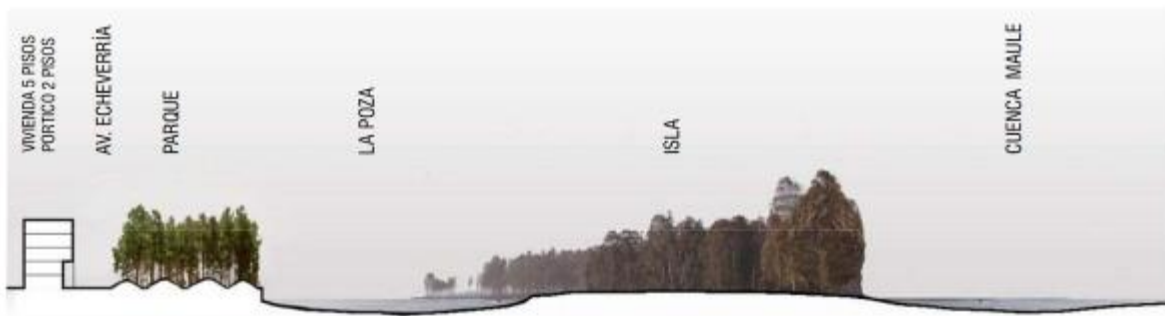
Imagen 14 / Corte esquemático de perfil de mitigación / Fuente: Términos de referencia, Parque Fluvial de Constitución (2011)
