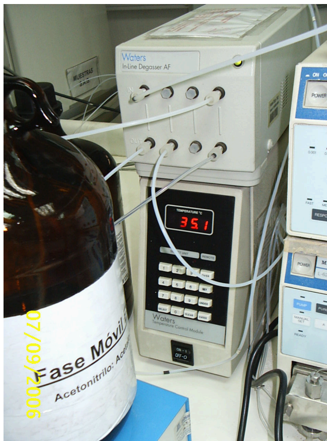
A.13: Módulo de control de temperatura y degasificador utilizados.
