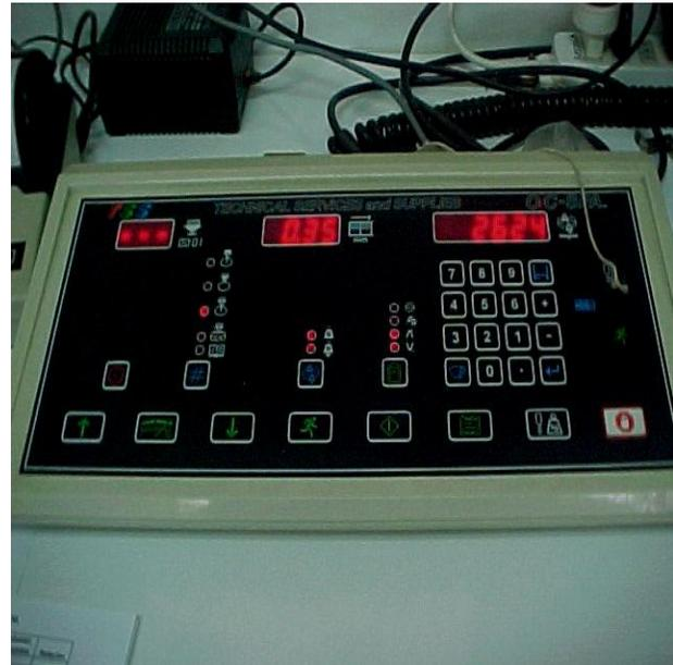
**B.7. Medición del color de la yema mediante el uso de un colorímetro ajustado a la escala de Roche®.**
