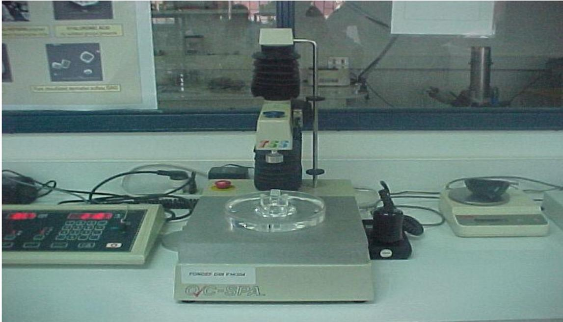
**B.6.- Medición de la deformación y resistencia de la cáscara a la fractura con un Durómetro TSS.**
