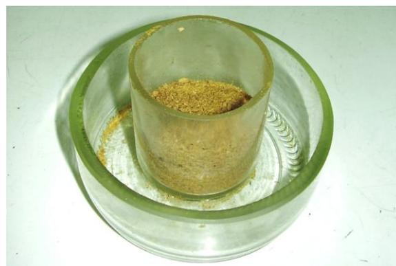
**Figura N° 6:** Posillo de vidrio de 8 cm de diámetro y 3 cm de alto con cilindro interno de 4 cm de diámetro y 4 cm de alto.
