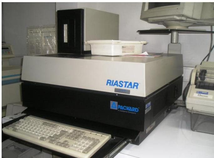
**Figura N° 17:** contador de radiación gamma Riastar Packard
