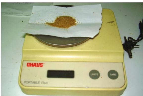
**Figura N° 5:** Pesaje de 10 g de dieta Champion Rata Laboratorio extruido, previamente molida, en balanza electrónica Portable Plus Ohaus.
