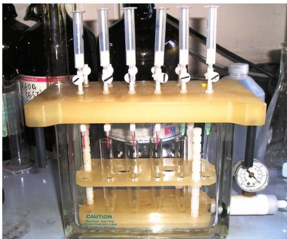
**Figura N° 15:** columnas de sílica Merck Lichrolut RP-18 conectadas a cámara de extracción por vacío Supelco.
