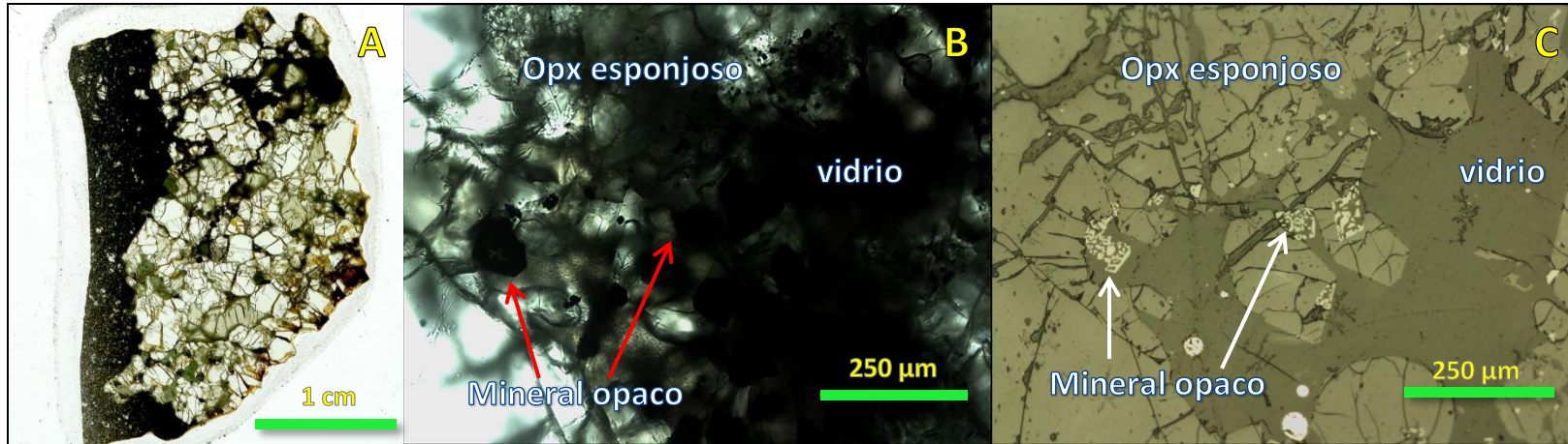
Figura Anexo 19: Muestra PM24-40. (A) Imagen corte obtenida con escáner Epson. (B)(C) Fotomicrografías a luz transmitida-nicoles paralelos y luz reflejada-nicoles paralelos mostrando bordes esponjosos en Opx y zona vítrea con cristales romboédricos opacos e sulfuros PM24-40-1A, 1B y 1C.
