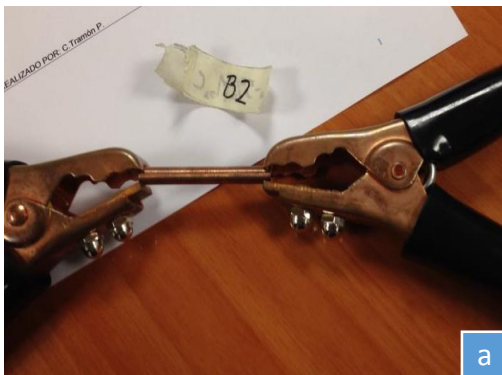
Figura 4-3 (a) Medición longitudinal completa de una de las muestras, (b) Medición media de la muestra.
