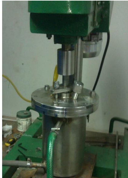
Figura 4-2 Molino attritor basado en el modelo Szegvari Attritor Grinding Mill (Taller del departamento de Ingeniería Mecánica)
