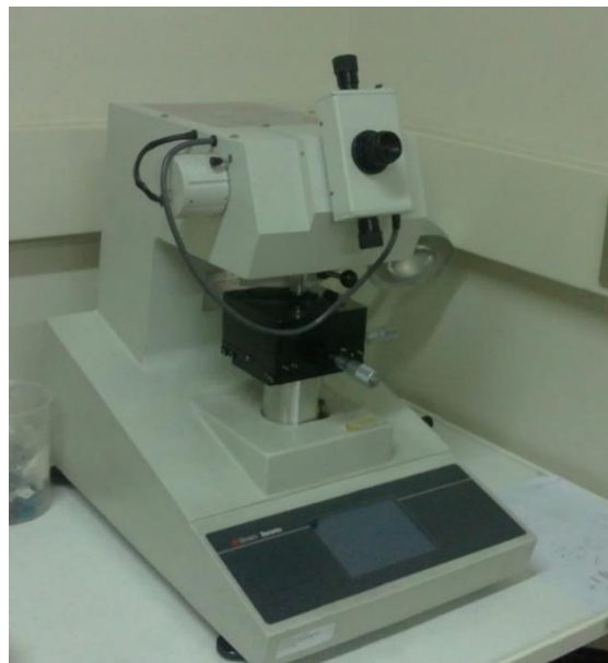
Figura 4-4 Microdurómetro perteneciente al Laboratorio de Polímeros del Departamento de Física
