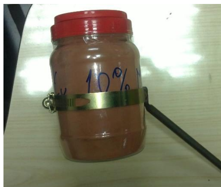
Figura 4-1 Recipiente puesto en el soporte para realizar la homogeneización de los polvos
