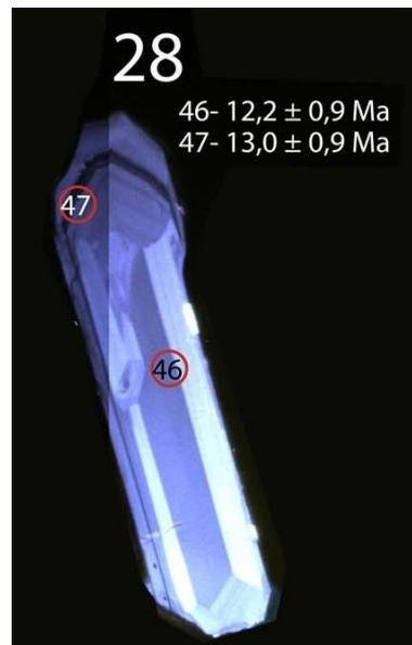
Figura 7.2. Cristal de circonio N° 28. Razón A:L = 0.21. Spot del láser (circunferencia roja) de 30  $\mu\text{m}$ .
