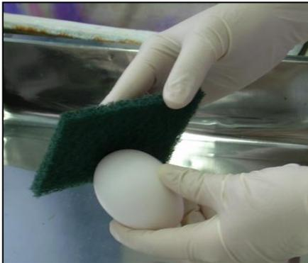
*Fotografía 5: Permeabilización de un huevo mediante método abrasivo con esponja*
