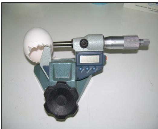
*Fotografía 4: Medición del espesor de la cáscara de un huevo a través del Micrómetro digital.*
