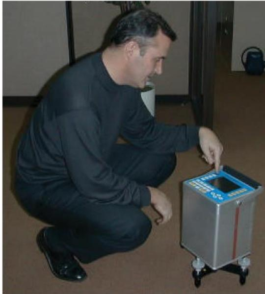
**Figura III.4:** Equipo Autograv Gravity Meter CG-5
