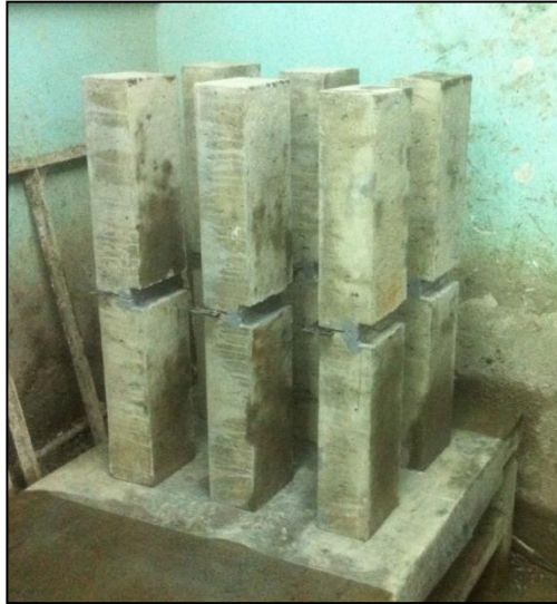
Figura B.12: Serie de vigas reparadas
