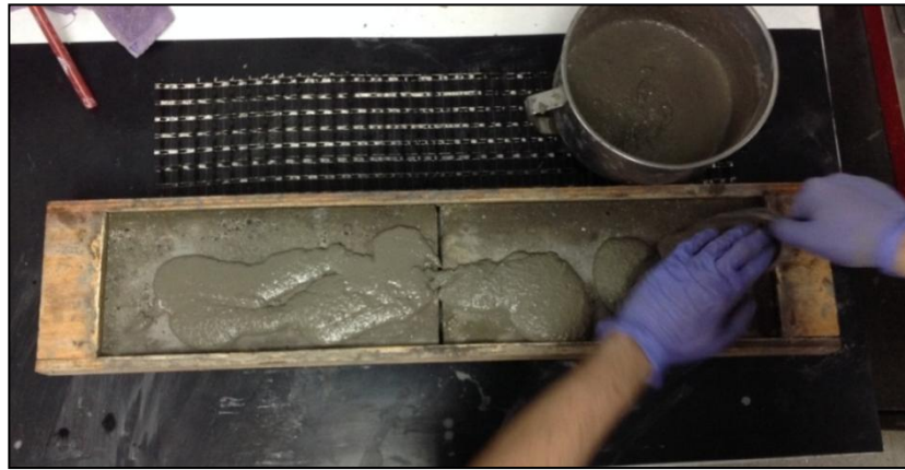
Figura 5.4: Aplicación de la primera capa de matriz
