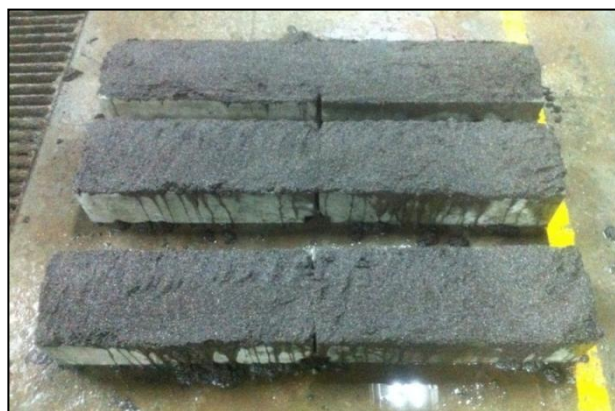
Figura 5.2: Aplicación de arena con ácido clorhídrico para la preparación de la superficie
