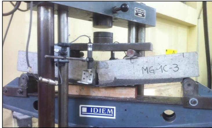
Figura 5.28: Modo de falla por rotura de fibra (MG-1C-1, MG-1C-2 y MG-1C-3)
