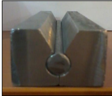
Figura 5.7: Rótula para ensayo de vigas
