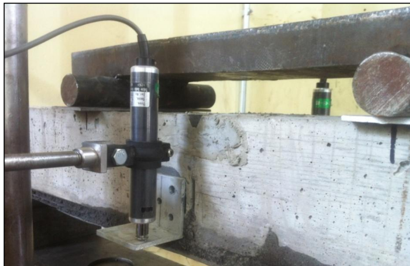
Figura 5.13: Detalle de la instrumentación de las vigas de ensayo
