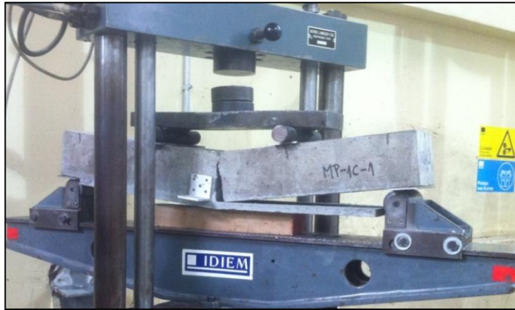
Figura 5.20: Modo de falla por adherencia (MP-1C-1)
