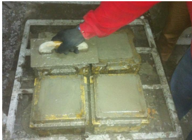
Figura B.8: Confección de 4 cubos como probetas de control para cada amasada
