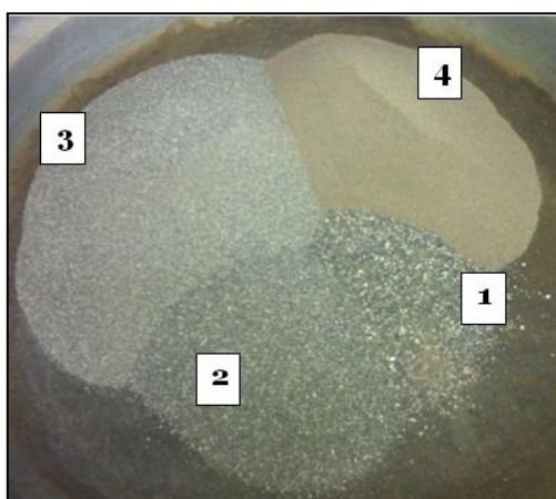
Figura 3.8: Fracciones y proporción de arena para morteros
