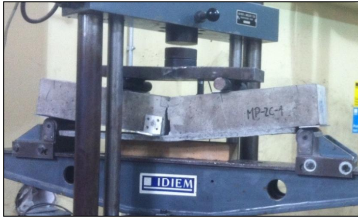
Figura 5.31: Modo de falla por adherencia (MP-2C-1)
