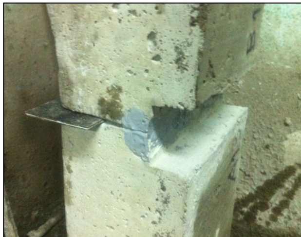
Figura B.11: Pegado de las vigas de ensayo
