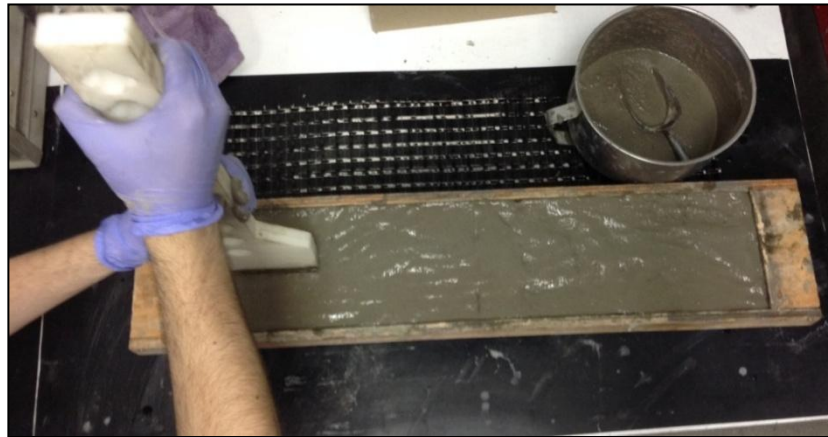
Figura 5.5: Compactación de la capa de matriz
