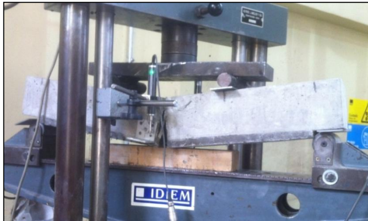
Figura 5.25: Modo de falla por rotura de fibra (MC-1C-3)
