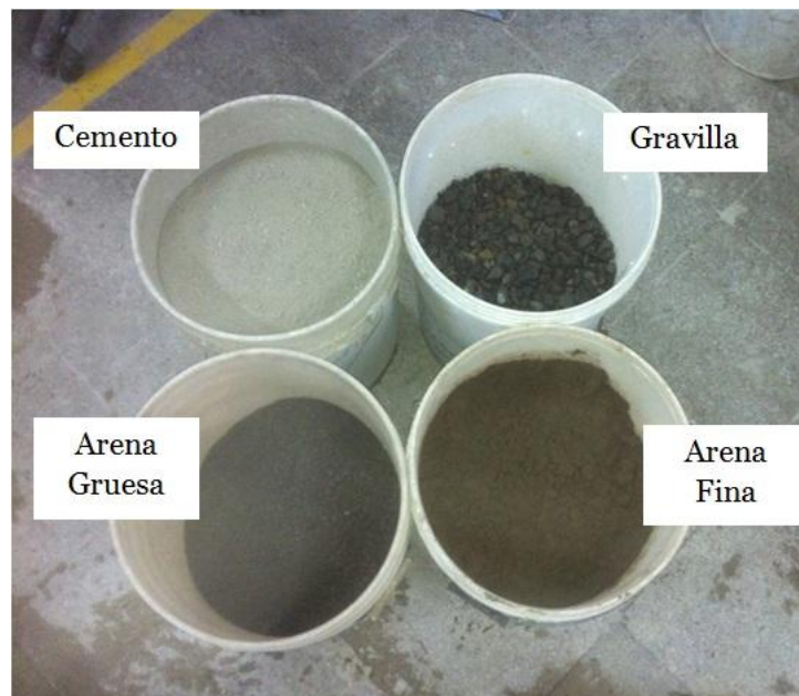
Figura B.5: Materiales utilizados para hormigón de vigas de ensayo
