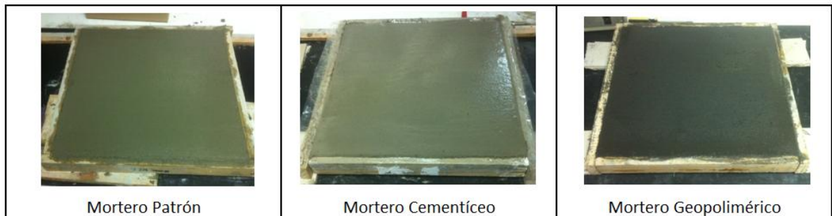
Figura 4.18: Diferentes tipos de recubrimientos para ensayo de adherencia
