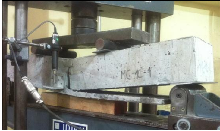
Figura 5.24: Modo de falla por adherencia (MC-1C-1 y MC-1C-2)
