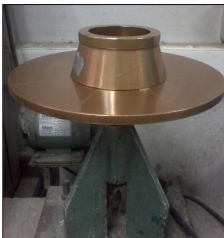
Figura 3.2: Mesa de fluidez para la determinación de la trabajabilidad
