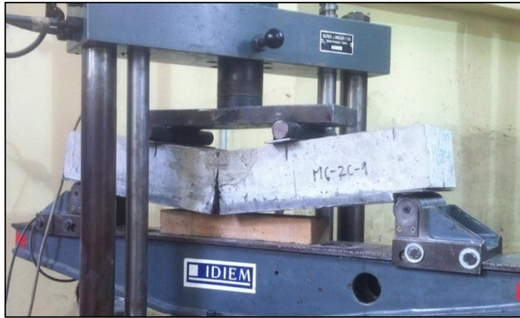
Figura 5.35: Modo de falla por rotura de fibra (MC-2C-1, MC-2C-2 y MC-2C-3)
