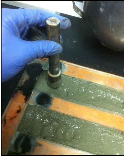
Figura 4.7: Compactación de la primera capa de matriz cementícea
