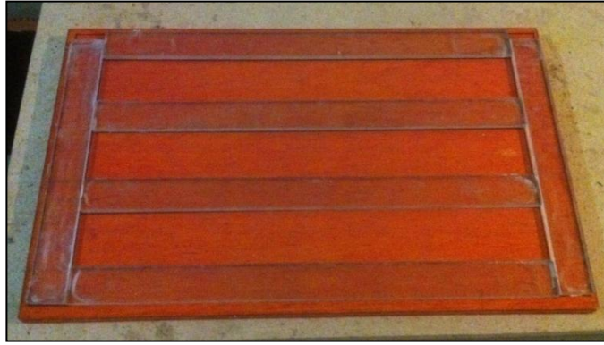
Figura 4.6: Moldajes para las probetas de ensayo a tracción
