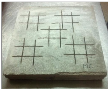
Figura 4.20: Cortes sobre el recubrimiento
