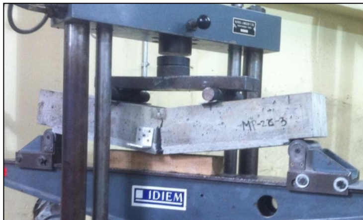
Figura 5.32: Modo de falla por rotura de fibra (MP-2C-2 y MP-2C-3)
