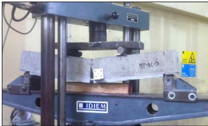
Figura 5.21: Modo de falla por rotura de fibra (MP-1C-2 y MP-1C-3)
