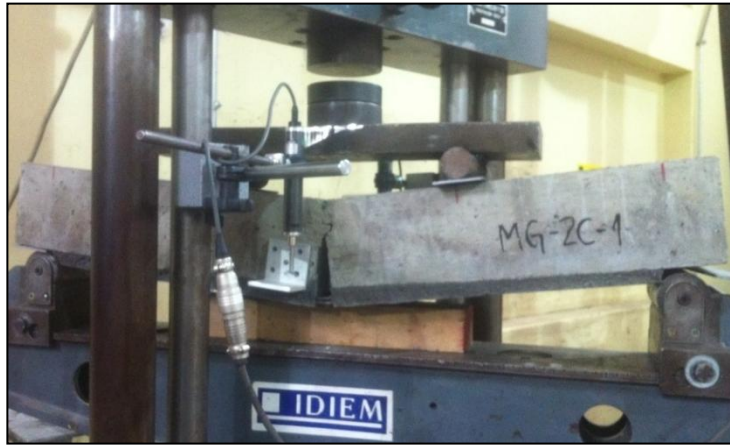
Figura 5.38: Modo de falla por rotura de fibra (MG-2C-1, MG-2C-2 y MG-2C-3)
