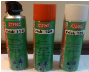
Figura 2: Kit de tres aerosoles. Limpiador (Crick 110), penetrador (Crick 120) y revelador (Crick 130).
