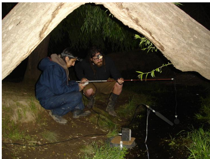
Figura 3: Llevando a cabo calibración con el micrófono de un sonómetro
