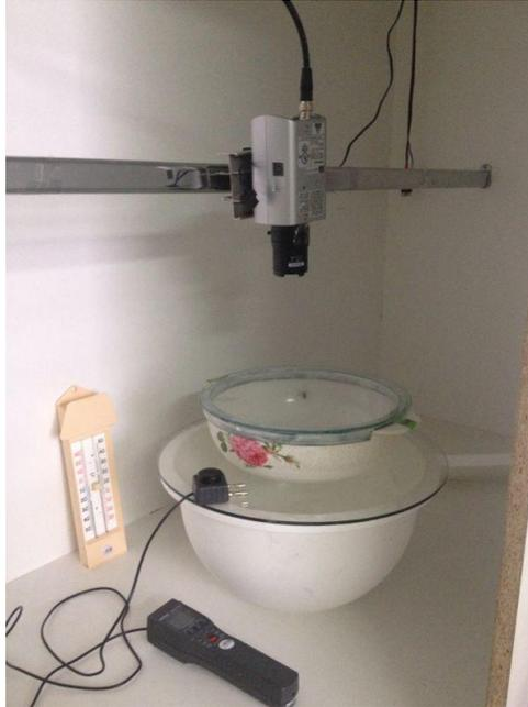
**Figura 3.** Sistema de grabación implementado para la grabación de la fase de luz. Aparece también el fotómetro con que se ajustó la intensidad de la luz y el termómetro de máxima y mínima.
