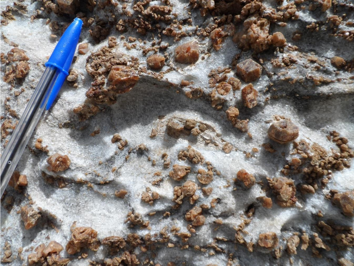
Fotografía 12: Detalle del afloramiento. Es posible apreciar el relieve negativo y color blanco, que corresponde a calcita, mientras que el relieve positivo y tonos pardos corresponden a granate.
