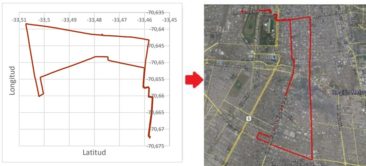
Figura 4.1 Parámetros GPS, latitud y longitud en gráfico de dos ejes y en representación satelital
