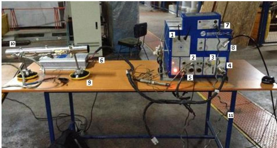
Figura 3.5 Montaje instrumentos necesarios SEMTECH G, en cuadros rojos se indica el número
