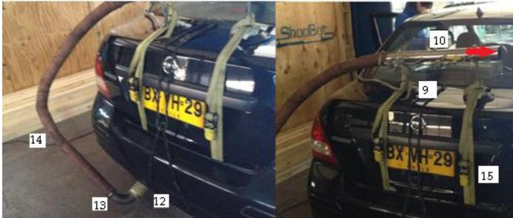
Figura 3.6 Montaje instrumentos sobre el vehículo, en rojo se indica el número de accesorios
