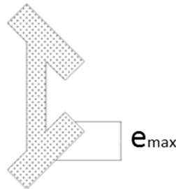
Figura 3.8: Error de paralelismo en el ala de un perfil (Lastra, 2012).
