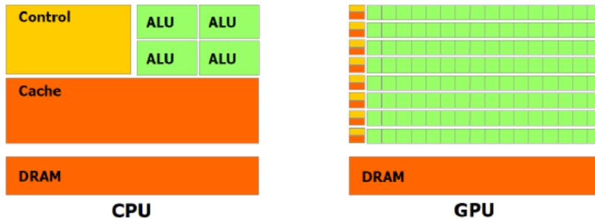
Figura 2.1: Comparación de la utilización de espacio en las arquitecturas de CPU y GPU.
