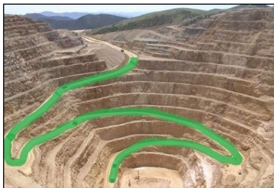
FIGURA 6 - RAMPA CON SWITCHBACK
