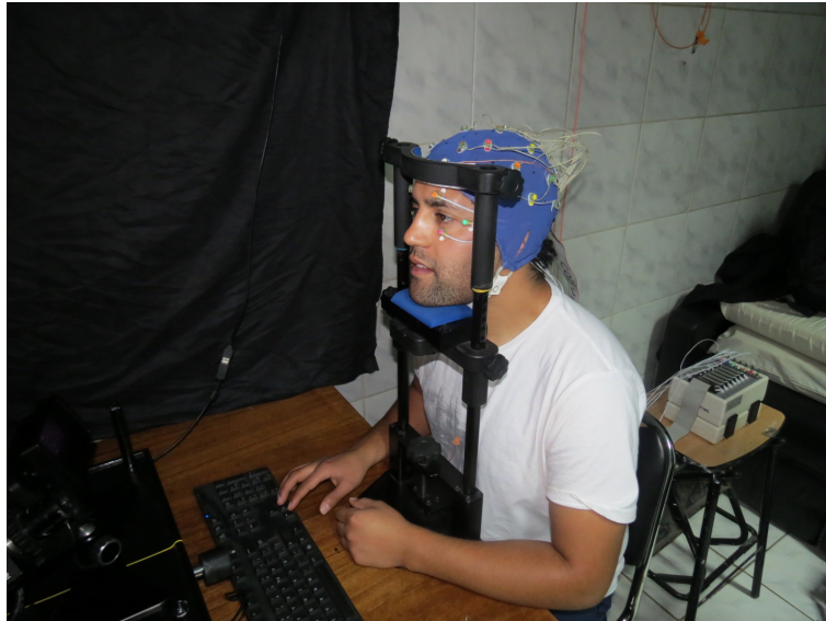
Figura 4.4: Sujeto con gorra y electrodos posicionado para el experimento. Fuente: Imagen propia.
