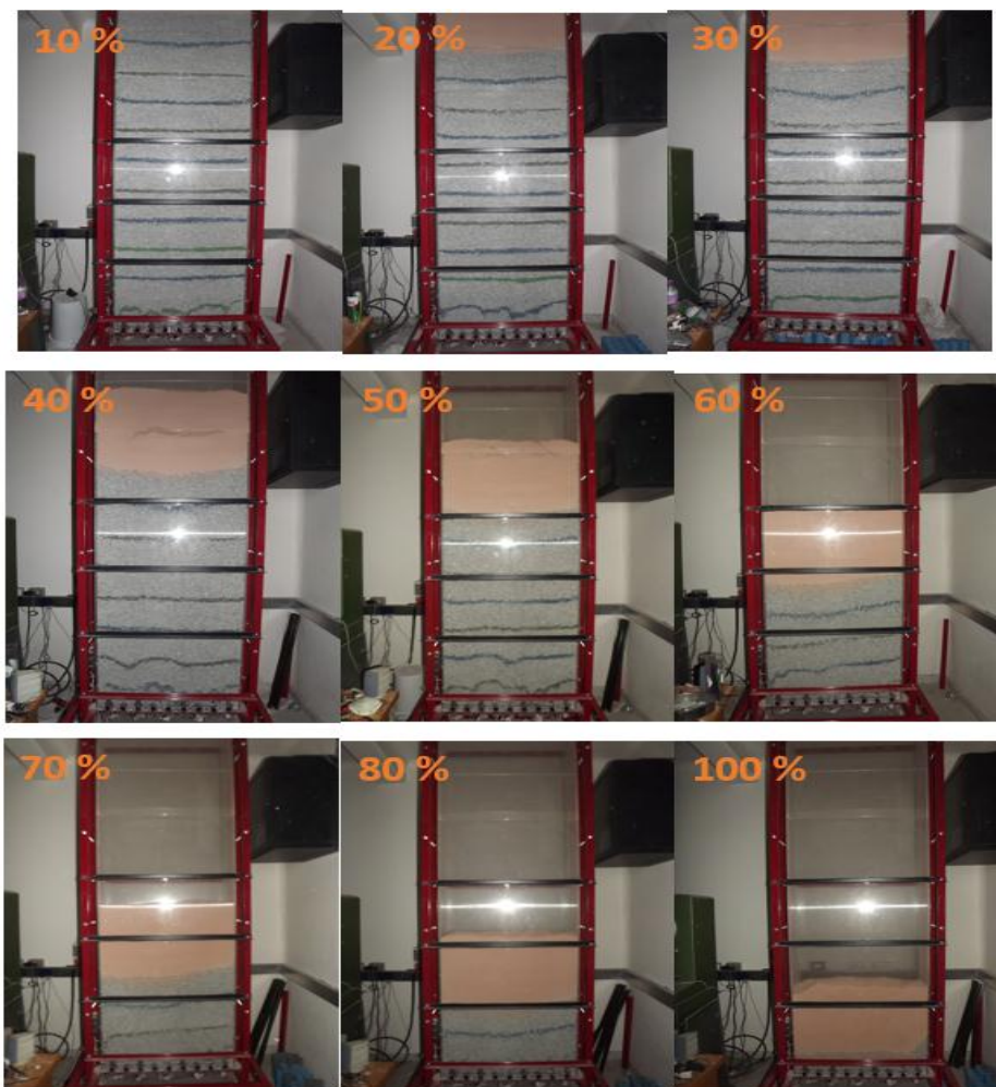
Figura 14: Imágenes de modelo físico a distintos porcentajes de extracción del material
