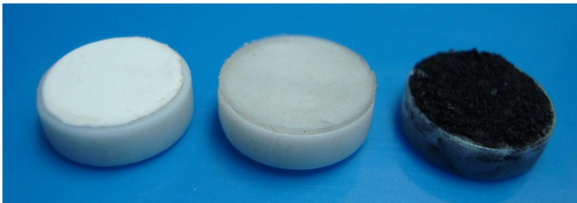
Figura 17: diversas fases adheridas al disco de teflón, de izquierda a derecha C18, PDMS, MWCNT.
