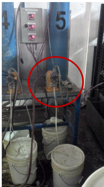
Figura 27. Bomba peristáltica, impulsando solución lixivante hacia columna 5.
