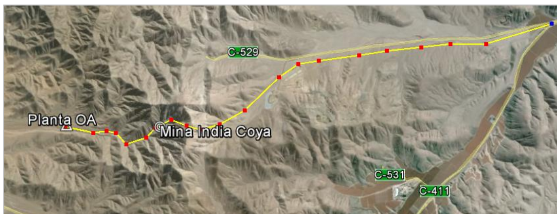
Figura 36 Escenario A - Abastecimiento Eléctrico/ Líneas 23 KV.
