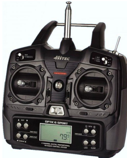
Figura 2.6: Mando de control de 6 canales con opciones de programación.
