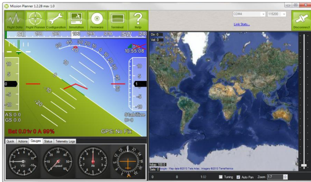
Figura 2.7: Interfaz gráfica del software Mission Planner, presentando un mapa para path-planning y mediciones en tiempo real de la nave
