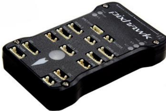
Figura 3.3: Controlador Pixhawk, de 3DRobotics, compatible con el firmware APM: Copter
