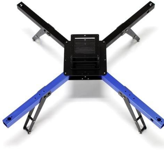
Figura 2.3: Ejemplo de estructura de un quad-rotor: brazos de aluminio; tren de aterrizaje y soporte central de fibra de vidrio [4]
