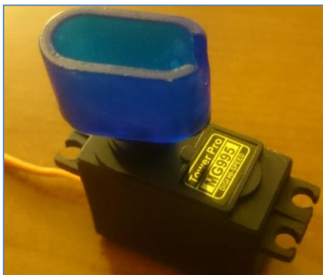
Figura 3-32: Motor SERVO adaptado para mover clavijas de instrumentos musicales.
