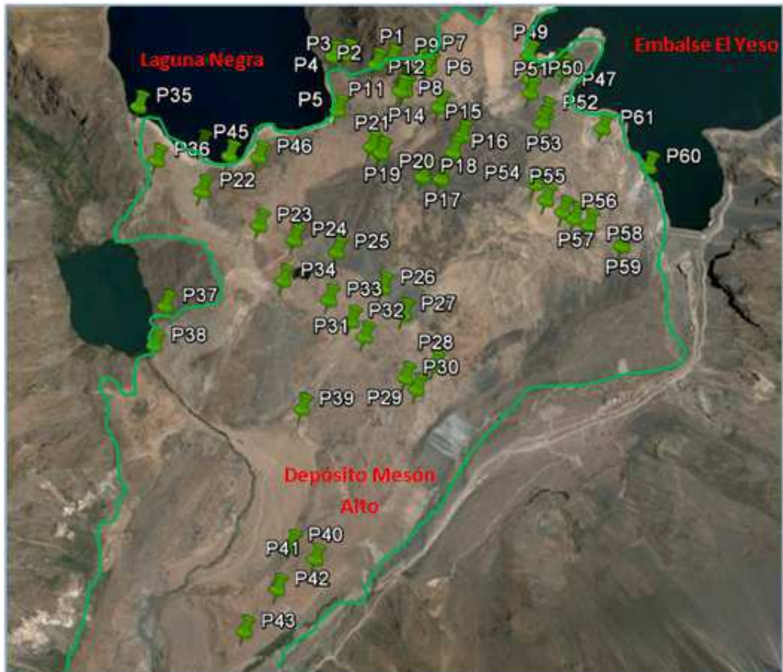
Figura 36: Puntos de control tomados en terreno. La línea verde corresponde al límite del depósito (Imagen: Google Earth).
