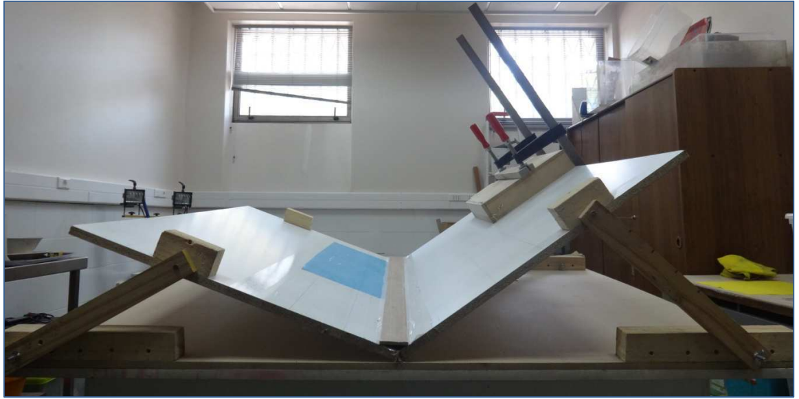
Figura 3: Dispositivo a utilizar para realización de modelos análogos. Laboratorio de modelos análogos, departamento de geología de la Universidad de Chile.
