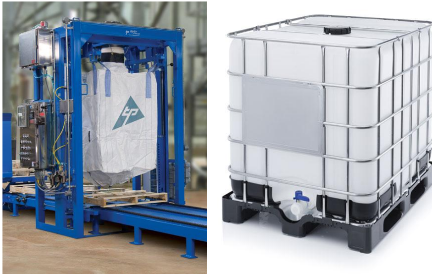
Figura 24. (Izquierda) Ejemplo de ensacadora de maxisacos [26]. (Derecha) Ejemplo de contenedor IBC de 1.000 litros [27].
