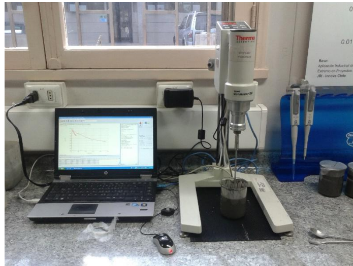
Figura 12. Reómetro utilizado en las pruebas de laboratorio.
