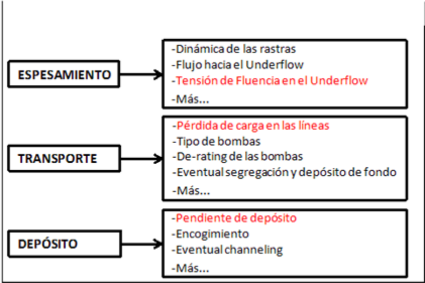
Figura 3. Efectos dependencia de la reología de los relaves en las etapas de espesamiento, transporte y depósito [4].
