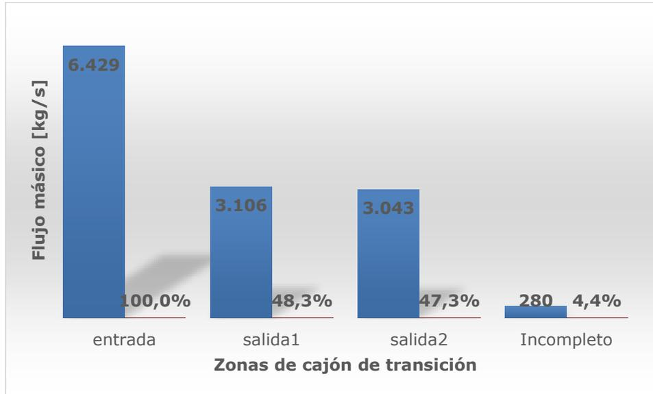
FIGURA 7.12 FLUJO MÁSSICO DE LA CANAleta DE ENTRADA Y LAS CAÑERÍAS DE SALIDA, JUNTO CON LA DIFERENCIA DE CAUDAL INCOMPLETO.
