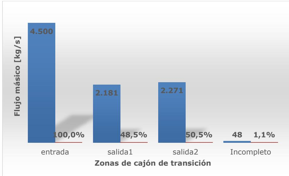
Figura 7.24 Flujo másico de la canaleta de entrada y las cañerías de salida, junto con la diferencia de caudal incompleto.
