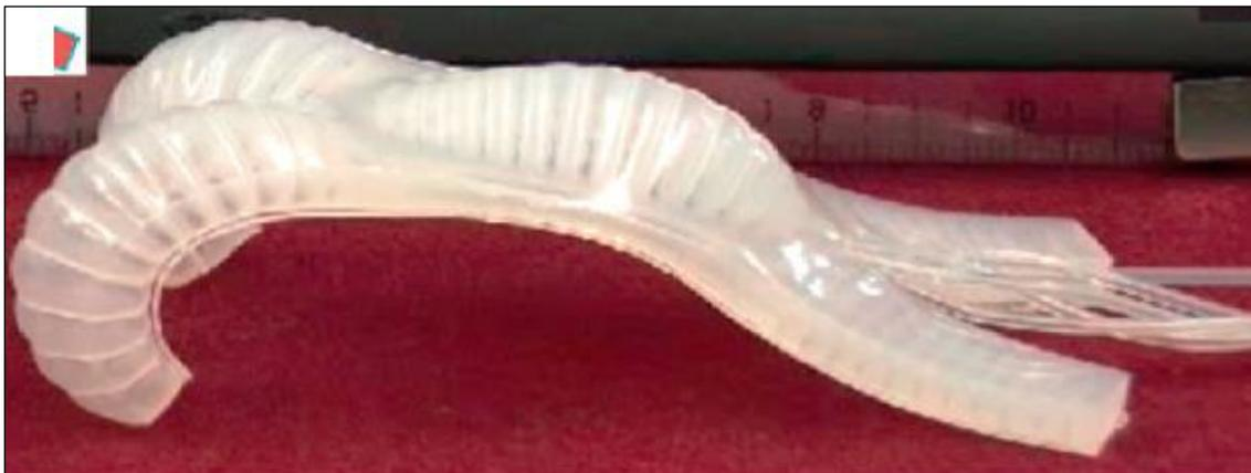
**Figura 10 – Robot blando accionado por aire comprimido. Fuente: [13]**
