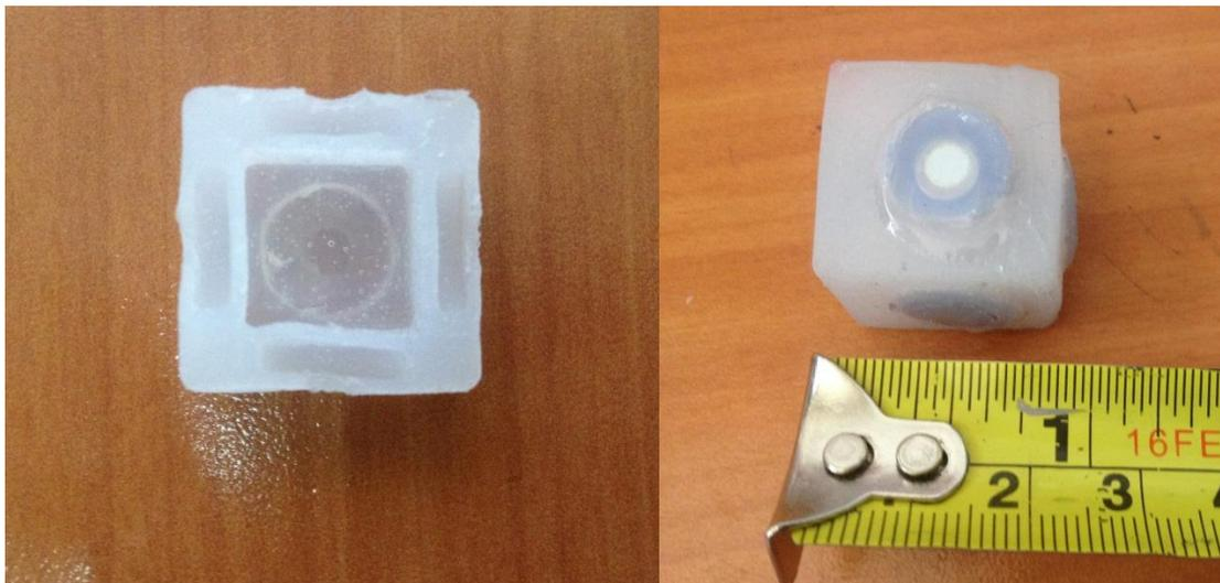
**Figura 38 – Corte transversal de cuerpo blando (izq) y módulo terminado (der).**
