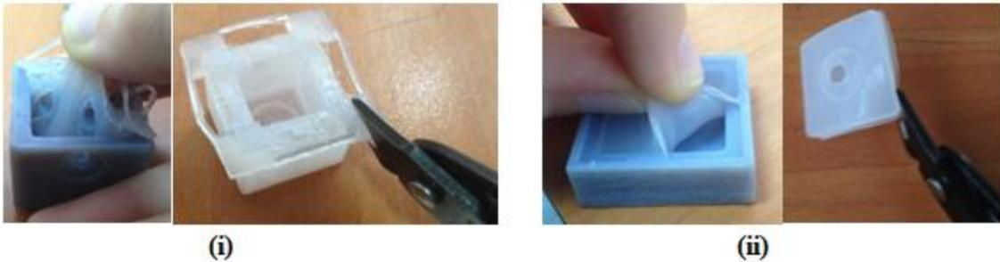
**Figura 35 – Desmolde y corte de rebabas.** (i) Desmolde y corte de rebabas para el cuerpo del molde 1. (ii) Desmolde y corte de rebabas para el cuerpo del molde 2.
