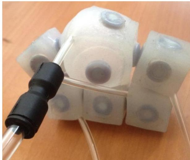
**Figura 44 – Seis módulos conectados y expansión del módulo medio superior (mediante jeringa)**
