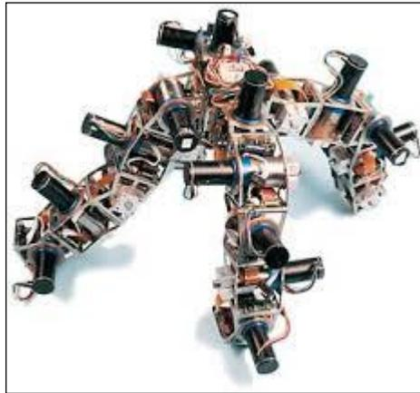
**Figura 6 – Robot modular PolyBot. Fuente: [6]**
