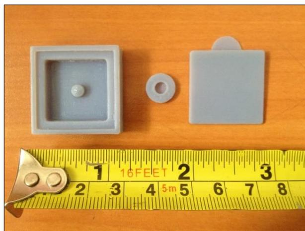
**Figura 33 – Molde 2 desarmado.** El disco del centro encaja en el centro del molde y al tapar con la pieza de la izquierda es posible obtener una lámina cuadrada de 20 mm de lado y 4 mm de espesor, con un bolsillo en forma de disco en el centro.
