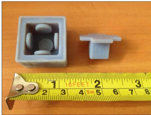
**Figura 32 – Molde 1 desarmado parcialmente.** Al cubrir con la pieza de la derecha el molde es posible obtener un cubo hueco de espesor 4 mm al que le falta la cara superior, y con bolsillos en forma de discos en las paredes.
