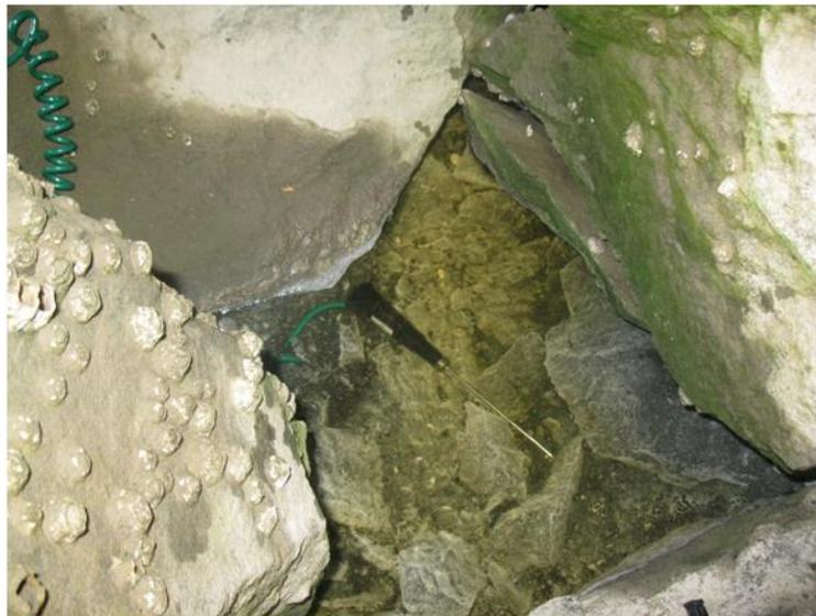
Figura 3.14: Vista del lugar de obtención de muestras de las aguas termales Concha. El color blanquecino de los rodados se debe a la existencia de finas costras salinas.
