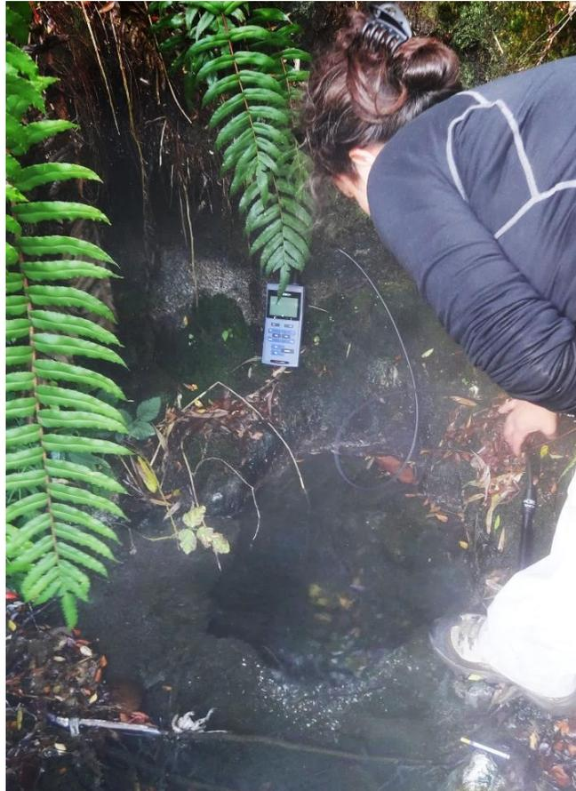
Figura 3.26: Vertiente caliente de las Termas Cahuelmó, el diámetro de la apertura mide 50 cm.
