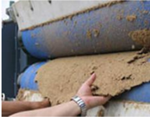
Figura 4-10: Sólidos deshidratados en filtro de banda.
