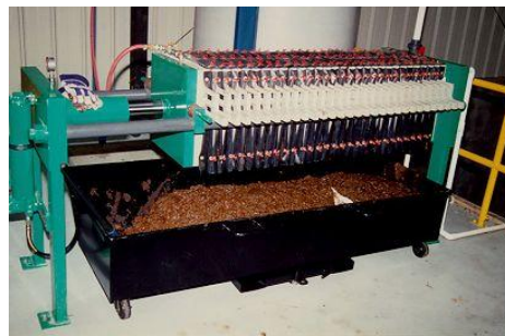
Figura 4-8: Deshidratación de sólidos con filtro prensa.
