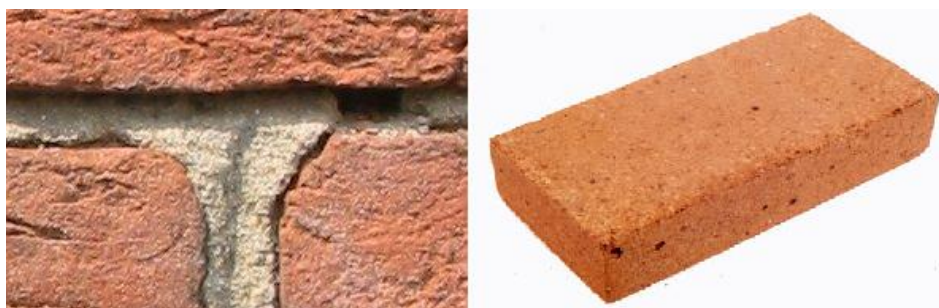
Figura 4-18: Morteros y ladrillos utilizando sólidos de aguas residuales.
