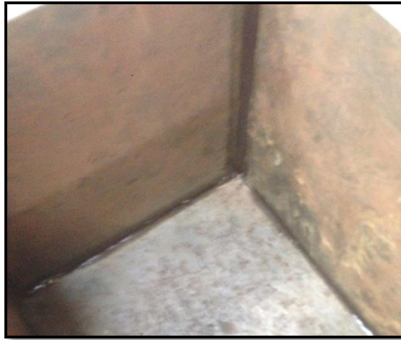
Figura 3.9: Sellado de los moldes de acero con silicona
