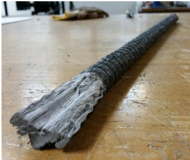
Figura 4.1: Imagen de la falla local generada en las barras producto del ensayo a tracción
