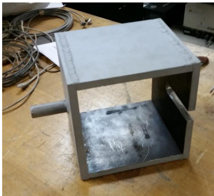
Figura 3.6: Caja de acero que funciona como mordaza para contener la probeta de hormigón.
