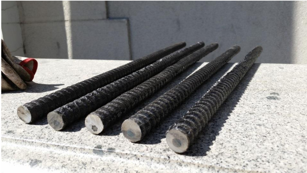
Figura 3.7: Cinco tipos de barras de fibra de vidrio reforzado
