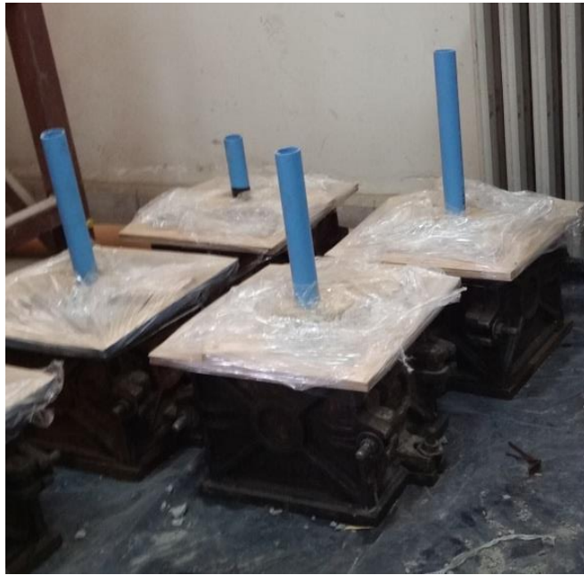
Figura 3.13: Probetas cubiertas para evitar la pérdida de humedad
