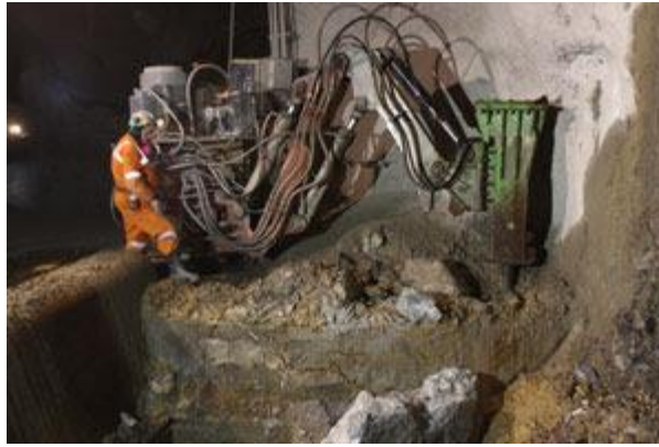
Figura 3-Martillo picador utilizado para reducir rocas que quedan atrapadas en las parrillas
