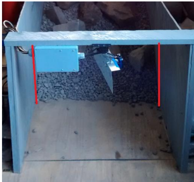
Figura 24- Límites del movimiento del servo motor destacados en rojo
