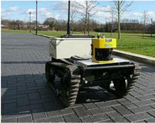
Figura 5- Robot con Lidar montado generando mapas
