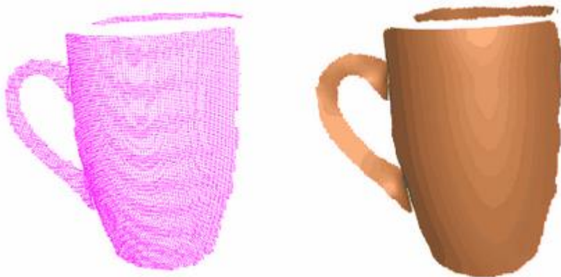
Figura 10- Reconstrucción de una superficie en base a una nube de datos utilizando algoritmos de pcl
