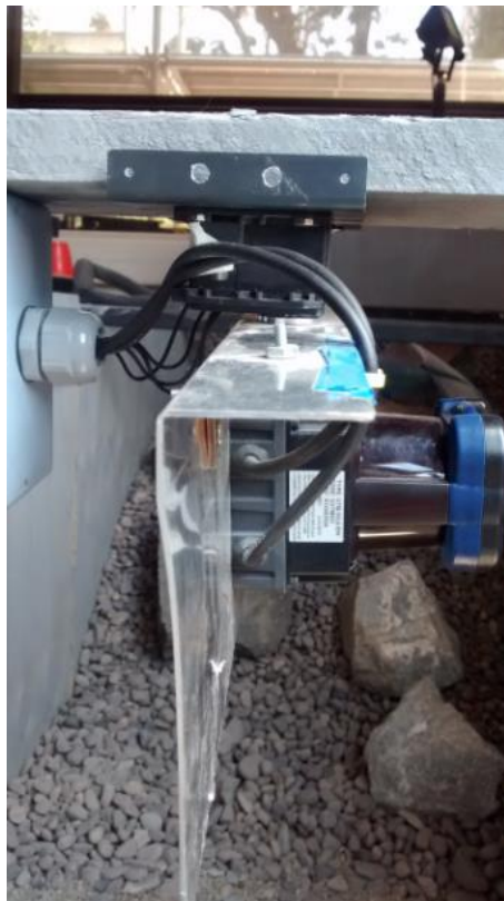
Figura 23- Láser montado de manera que gire sobre el eje Z.
