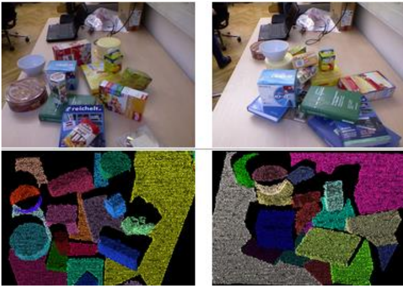
Figura 9- Ejemplos de segmentación de objetos sobre una mesa utilizando la librería PCL
