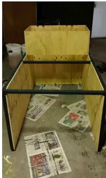
Figura 17- Estructura metálica con los paneles de madera apernados
