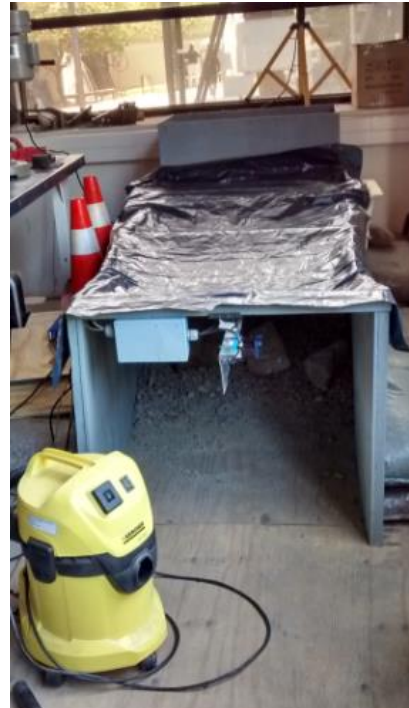
Figura 67- Experimento de polvo realizado cubriendo la maqueta y agitando gravilla dentro de esta.
