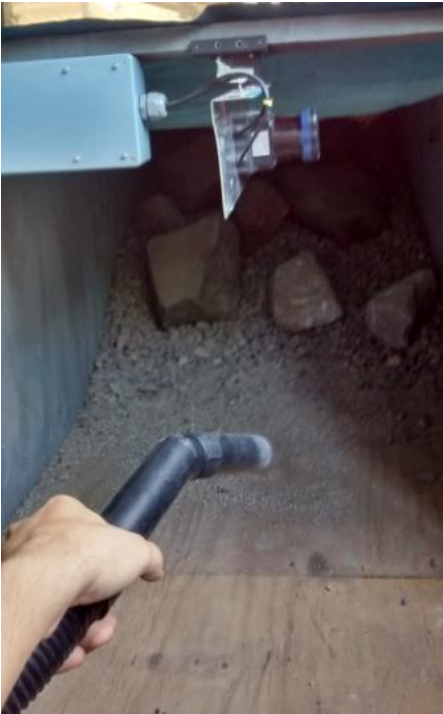
Figura 67- Experimento de polvo realizado cubriendo la maqueta y agitando gravilla dentro de esta.
