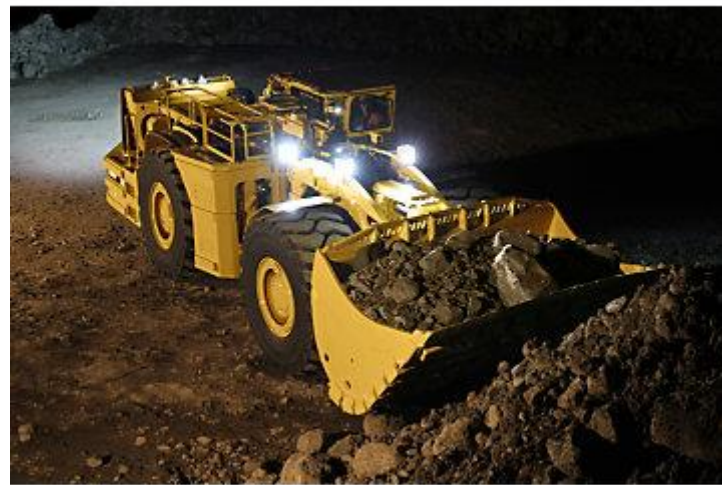
Figura 1- LHD CAT desde dos perspectivas cargando mineral
