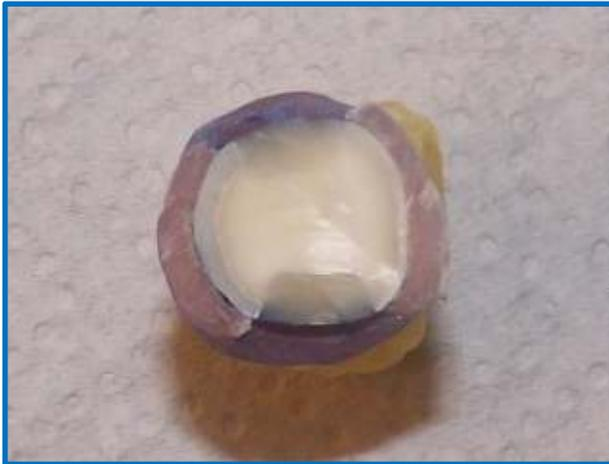
Estos cortes se visualizaron a través de un microscopio óptico con una grilla graduada, lo que permitió medir el grado de penetración del colorante y de esa manera obtener su porcentaje de penetración.
