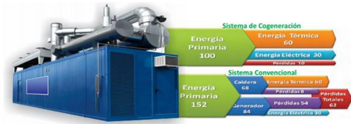
Figura 3-17: Esquema de la distribución de la energía en un sistema CHP [26].
