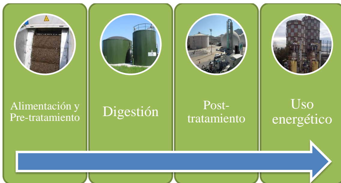
Figura 3-6: Esquema de las etapas de producción de biogás
