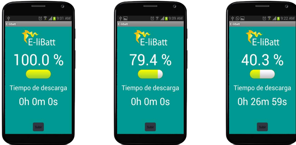
Figura 28. Elibatt - Funcionamiento de la aplicación en su vista usuario donde se indica el Estado de Carga y el pronóstico del tiempo de descarga de la batería
