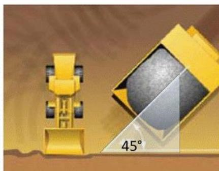
Ilustración 13: Ubicación de cargador y camión en frente de ancho mínimo
