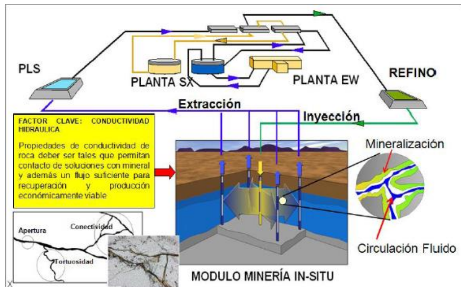
Figura 2: Lixiviación in situ convencional
