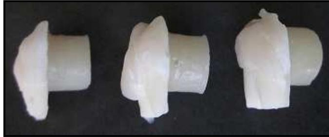
**Fig.8.** Ejemplares grupo B. La ruptura del mango de composite se produjo antes de la descementación del cilindro de composite.
