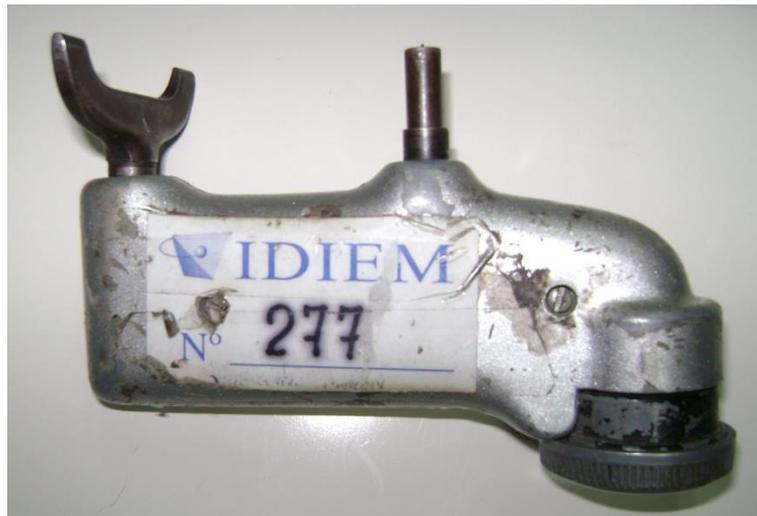
Fig.3 Durómetro tipo Barcol
