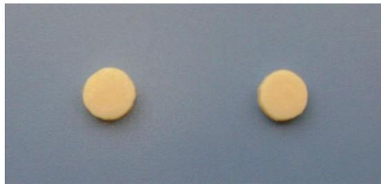
Fig.2 Cuerpos de prueba de cemento en base a resina compuesta
