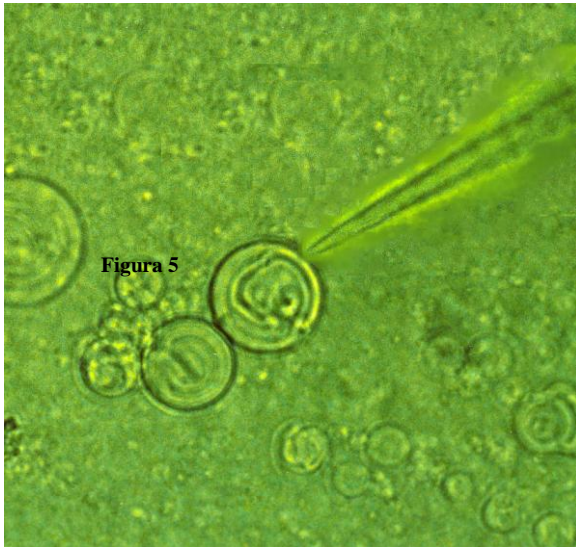
A.- Pipeta de patch clamp aproximándose a un liposoma
