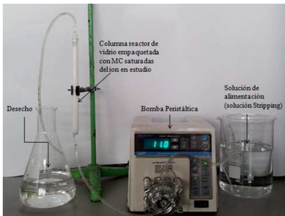
Fig. 7. Sistema continuo de desorción utilizado.
