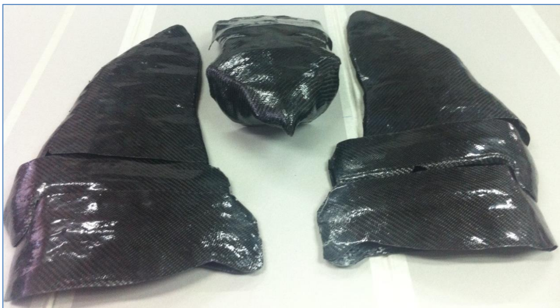
Figura 61: Moldes de fibra de carbono definitivos para el ornitóptero.
