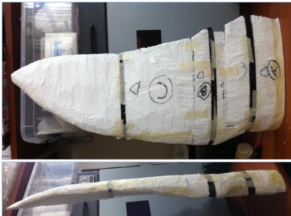
Figura 57: Molde de plumavit del ala derecha del ornitóptero.
