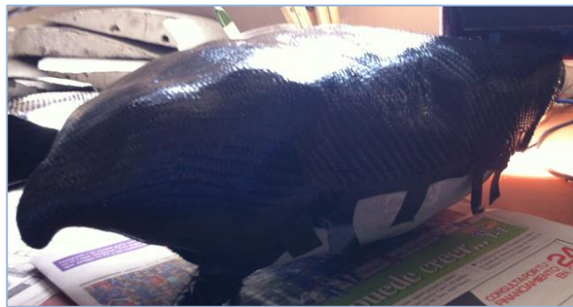
Figura 59: Molde del torso de fibra de carbono en el molde.
