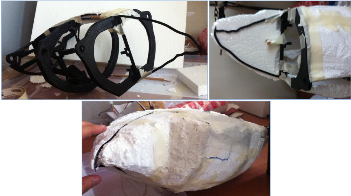
Figura 56: Molde de plumavit del torso del ornitóptero.
