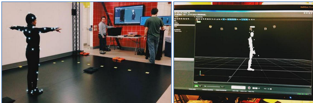
Figura 25: Ejemplo de implementación del OptiTrack en una persona.
