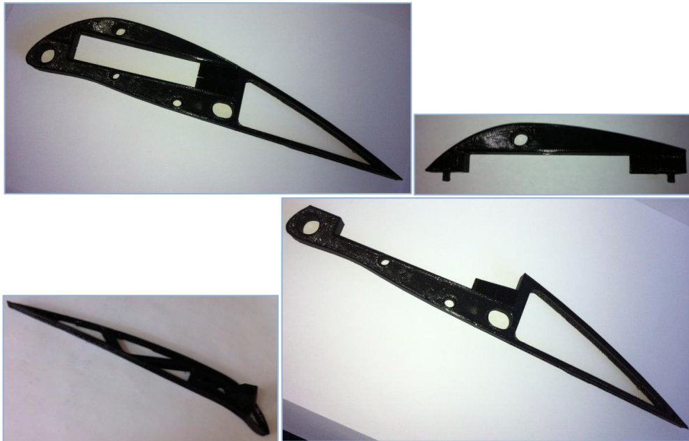
Figura 50: A la izquierda superior se muestra el Perfil 1, a la izquierda inferior el Perfil 3. A la derecha se muestra las 2 piezas que juntas forman el Perfil 2.
