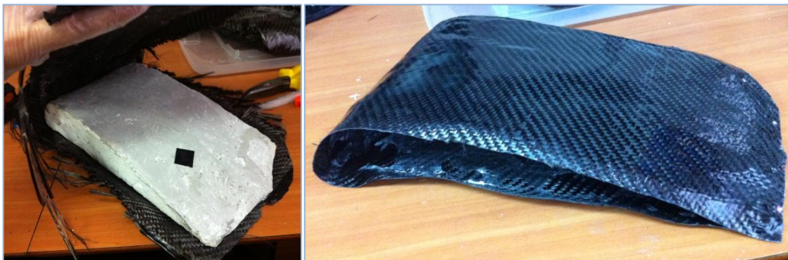
Figura 60: Molde del Perfil 1 de fibra de carbono en el molde.
