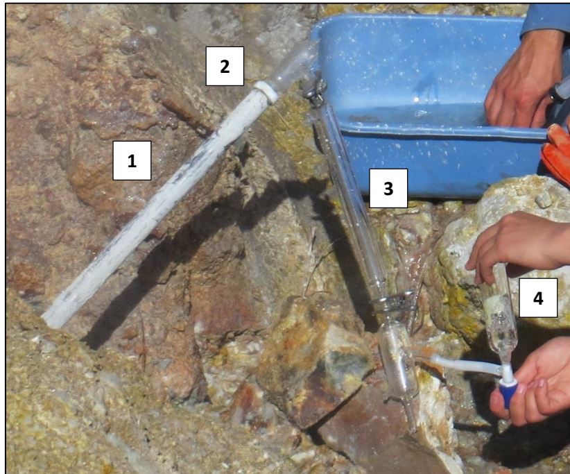
Figura 3. 6. Muestreo de gas con ampolla de Giggenbach. Se muestra la línea para muestreo de emisiones gaseosas. (1) Tubo de titanio. (2) Anillo de teflón. (3) Línea de vidrio pyrex. (4) Ampolla de Giggenbach. Imagen corresponde al punto de muestreo NC-QA-FI.
